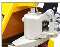
pompe en acier galvanisé option levée rapide
